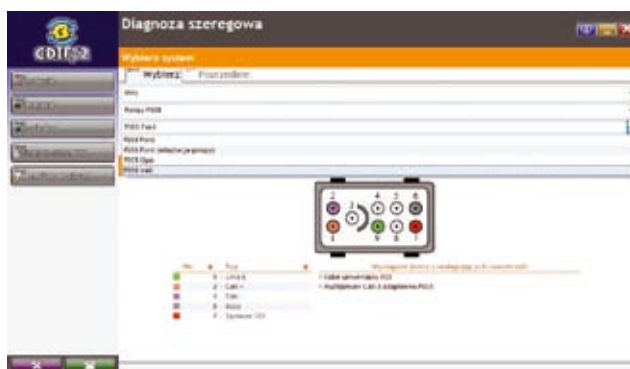
Widok okna programu CDIF2 – rozkład pinów złącza
