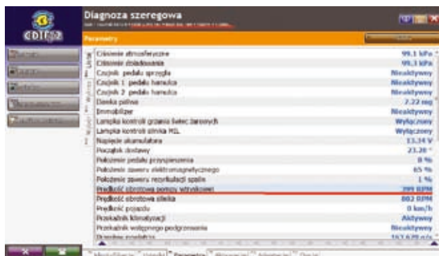
Okno programu CDIF2 – diagnoza szeregową sterownika Bosch EDC15M
