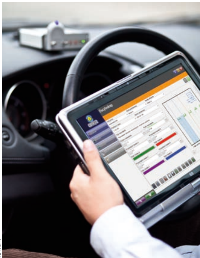
Fot. 1. Tester CDIF2, oprócz diagnostyki szeregowej, wyposażony jest w sterownik, generator oraz 4-kanalowy oscyloskop
